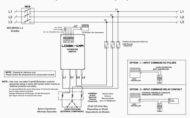
Diagrama de Conexión / Wiring Diagram
